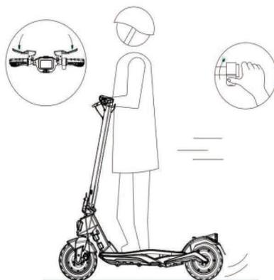
4. Rilasciare l'acceleratore per rallentare lentamente e tenere la maniglia del freno per le frenate di emergenza.
