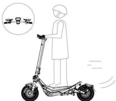
4. Rilasciare l'acceleratore per rallentare lentamente e tenere la maniglia del freno per le frenate di emergenza .
